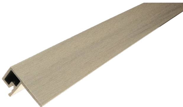
Listwy narożnikowe lamelowe z płaskim bokiem 50 × 84 × 2950 mm eleganckie rozwiązanie narożne, które wizualnie łączy elewację lamelową z gładką powierzchnią.
