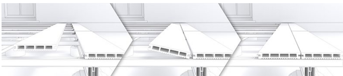
13. Umieść i przykręć klipsy montażowe, które same ustalają odpowiednią dylatację. Każdą kolejną deskę układaj poprzez lekkie uchylenie podczas wsuwania w klipsy.
