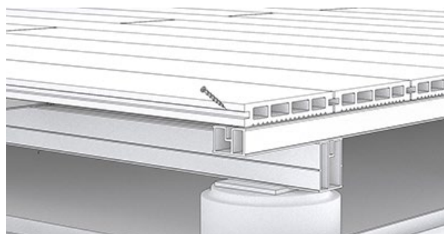
15. Przykręć uprzednio nawierconą deskę, zachowując kąt 45°.
